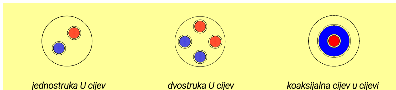
Slika 51. Izvedbe izmjenjivača u tlu
