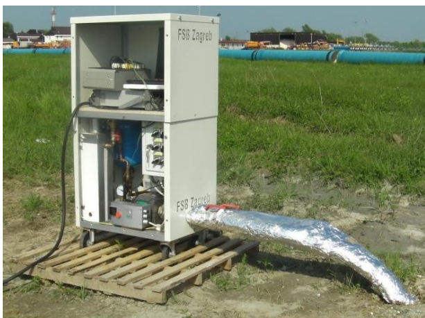
Slika 53. Prvi terensko mjerenje toplinski svojstva tla u Hrvatskoj, IKEA Rugvica 2011. (toplinska vodljivost tla \lambda = 1,73 W/(m*K), toplinski otpor bušotine R_b = 0,076 (m*K)/W, temperatura toplinski neporemećenog tla \vartheta_{tla} = 14,5 °C)
