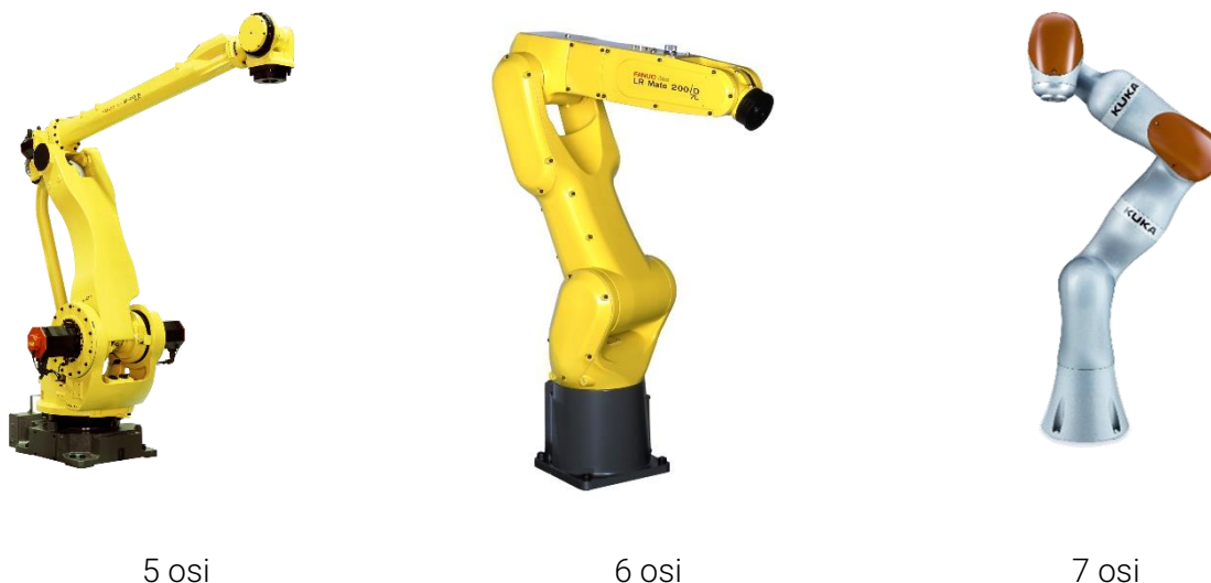
Slika 4.1 Roboti s različitim brojem osi
