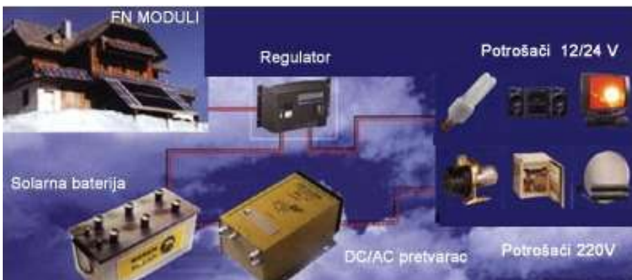
Slika 53. Izvan mrežni fotonaponski sustav - osnovni dijelovi [12]
