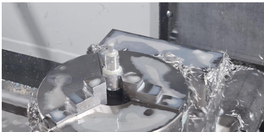
Slika 4. Izrada spojke na troosnoj glodalici
