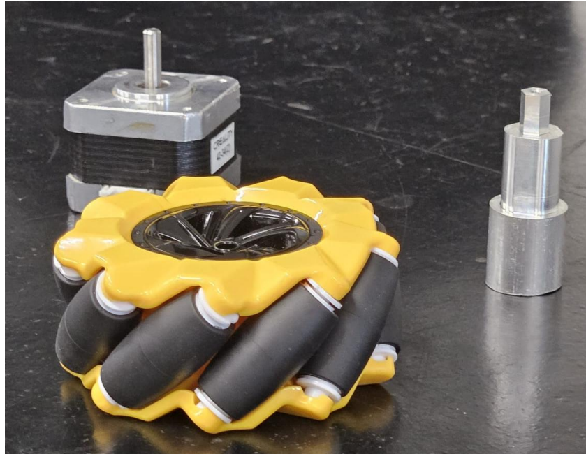
Slika 3. Izrađena spojka od aluminija
